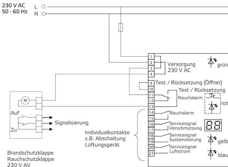
Ausführungsbeispiel der Verkabelung. Versorgung der Brand- / Rauchschutzklappe kann auch bauseits erfolgen. Alternativ kann die Brand- / Rauchschutzklappe auch über Klemme 14 + 15 angefahren werden. Klemme 9 + 10 (Öffnerkontakt für externen Taster)
